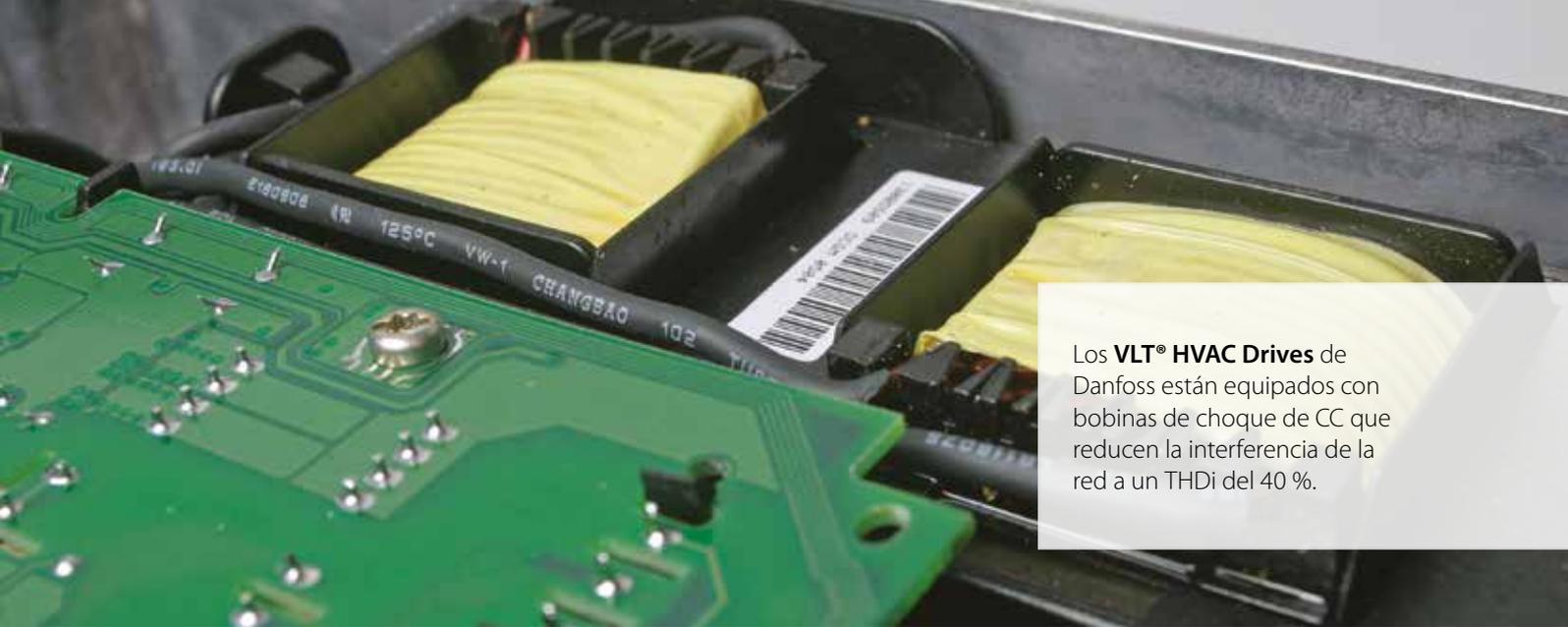
Los **VLT® HVAC Drives** de Danfoss están equipados con bobinas de choque de CC que reducen la interferencia de la red a un THDi del 40 %.
